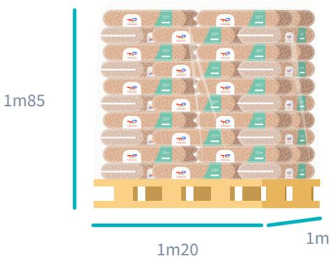
Les dimensions des palettes de pellets sont indiquées sur l'image de gauche. L'espace de stockage doit donc être adapté à ce format. Le livreur pourra approcher la palette au plus près, selon les conditions d'accès, si accessible avec le chariot élévateur.
