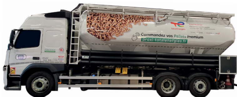
Camion de livraison pellets en vrac
